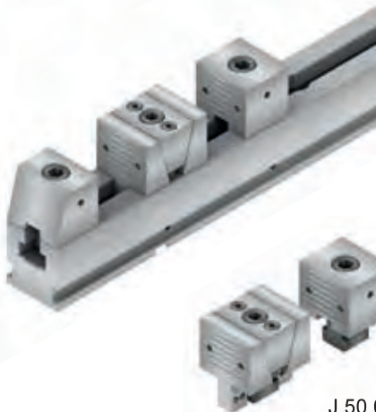
Morsa multipresa taglia 50 completo di n° 1 presa pezzo TIPO "C" (2x1) corsa 2+2mm
