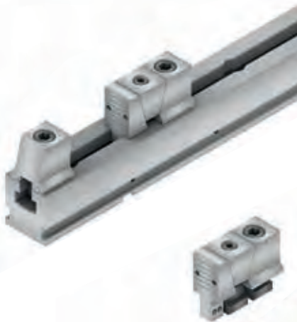
Morsa multipresa taglia 50 completo di n° 1 presa pezzo taglia 30 TIPO "A" (traslante) corsa 4mm
